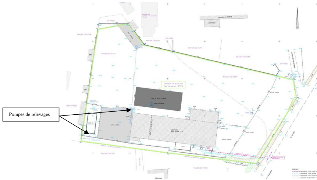
Figure 26 : Plan du réseau pluvial
