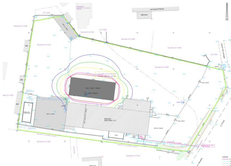
Figure 21 : Incendie de l'aire de réception des VHU à dépolluer – cartographie des effets
